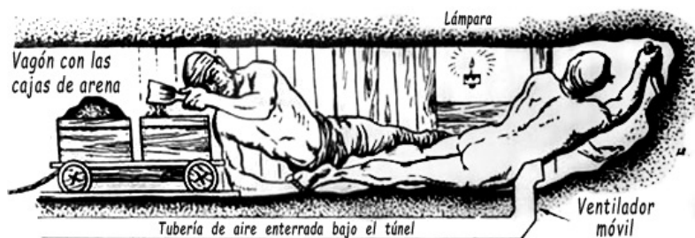
Cómo trabajan los dos cavadores en la vanguardia del túnel.
